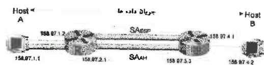
شکل ۳: جریان داده IPsec در حالت تونل
