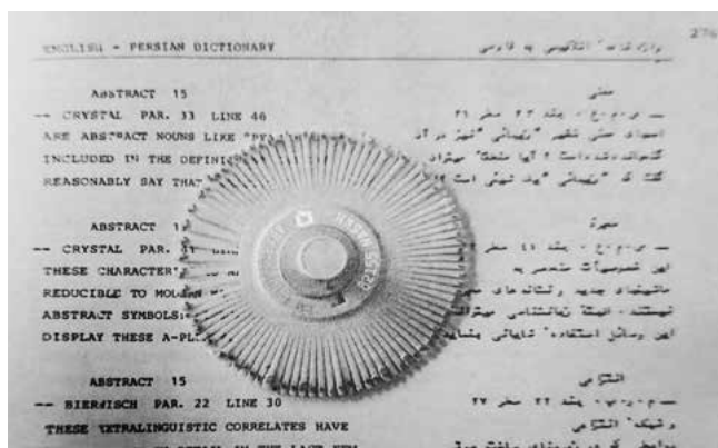
تصویر ۳۱- چرخ حروف فارسی و عربی چاپگر Daisy Wheel
