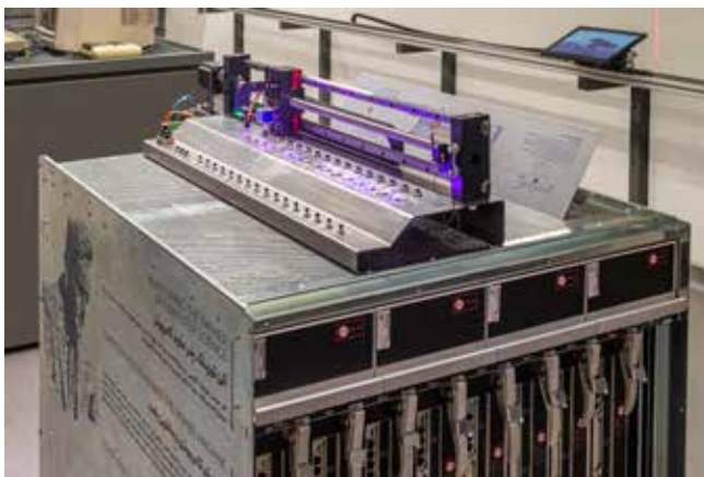
مدل فیزیکی ماشین تورینگ، طراحی و ساخت توسط تیم توسعه خلاق موزه کامپیوتر ایران
