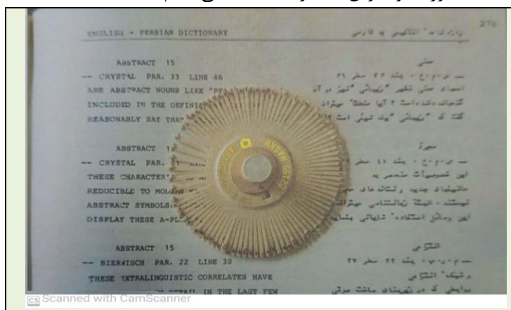
تصویر ۳۱- چرخ حروف فارسی و عربی چاپگر Daisy Wheel
